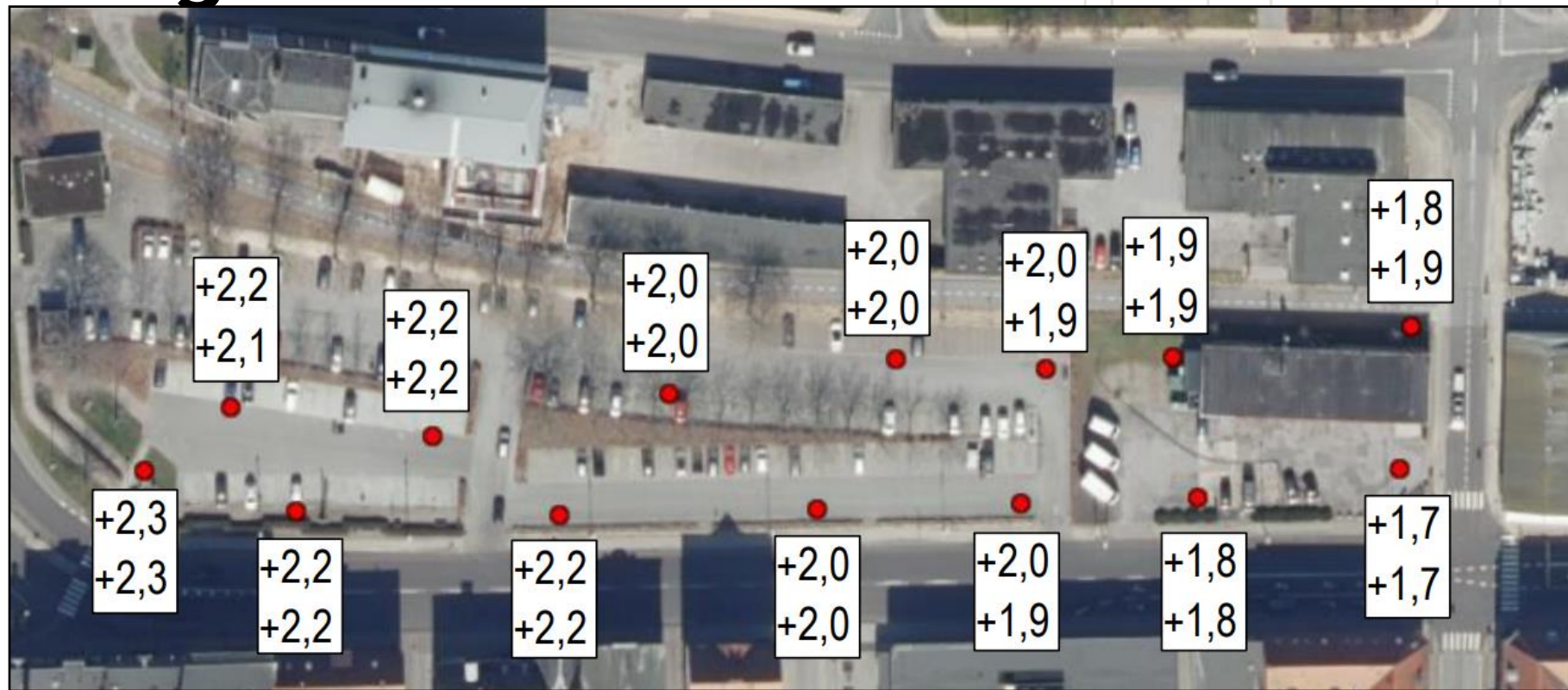
Figur 2: Målt grundvandsspejl i dybtliggende sandlag. Øverste tal = september 2022, nederste tal = oktober 2022. oktober 2022. Note * markerer, at der er hydraulisk forbindelse til det underliggende sandlag.
