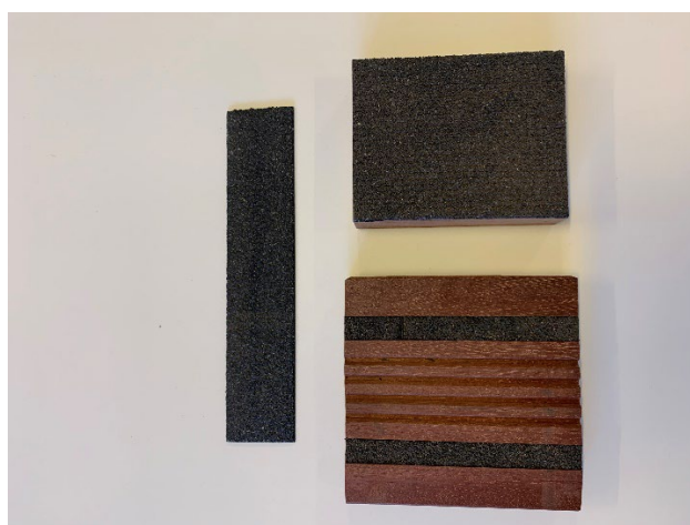
Fig. 3: Eksempler på skridsikring på træbroer.
