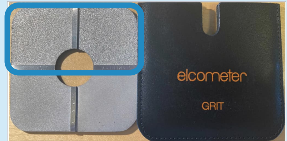
Figur 7-1 Billedet viser en referenceplade iht. ISO 8503-1 /-2 – hér opnået ved blæserensning med skarpkornet blæsemiddel på stål. De to med blåt indrammede felter svarer til det man bør tilstræbe ved rensning af betanooverflader.
